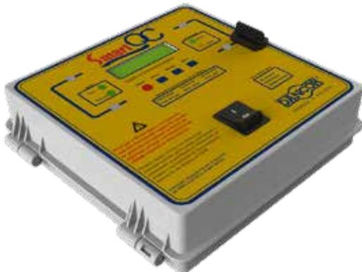
O gerenciador Smart QC com amperímetro, voltímetro e horímetro digitais com display LCD foi desenvolvido para fornecer ao usuário o máximo de informações, visando o controle operacional da bomba. Nas versões monofásica e trifásica, o gerenciador é empregado no acionamento, proteção, controle e monitoramento do tempo de funcionamento de bombas submersas.
